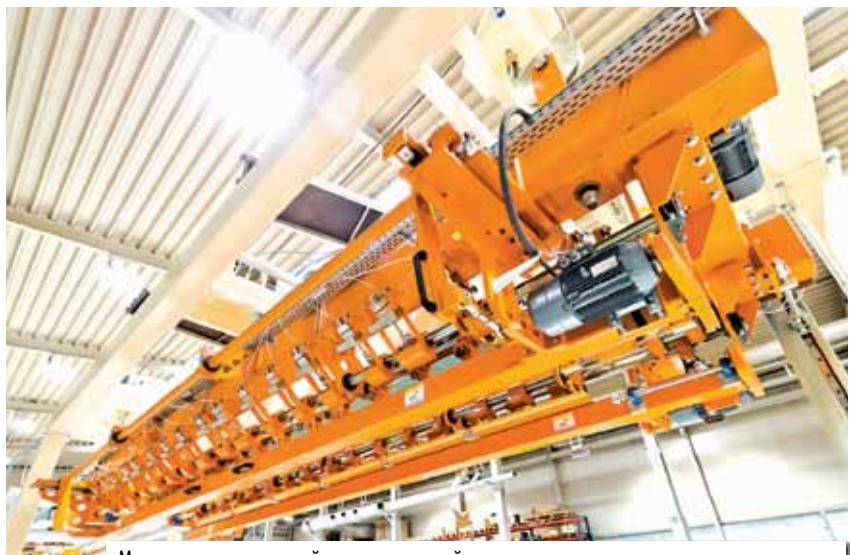
Модуль вертикальной резки с устройством для нарезки захватных карманов
