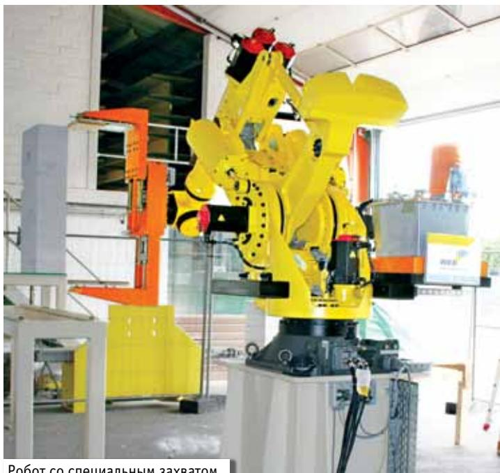
Робот со специальным захватом
