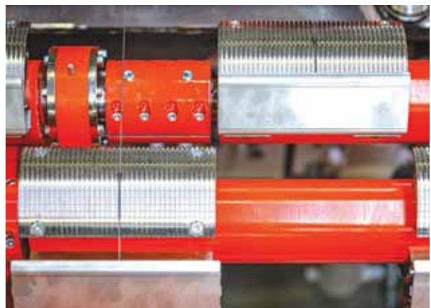
Направляющие для струн на устройстве поперечной резки
